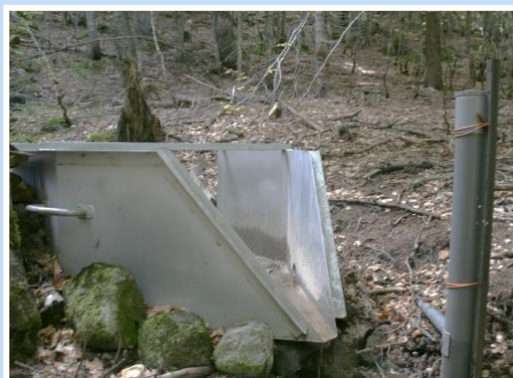
Photo B : Station de jaugeage H-Flume à l'exutoire d'une zone humide
